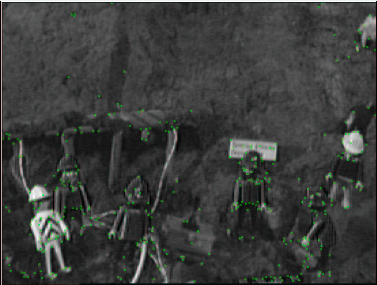
Figure D.18 – Détection de coins couleur en précision quart de pixel (détail des “personnages”).
