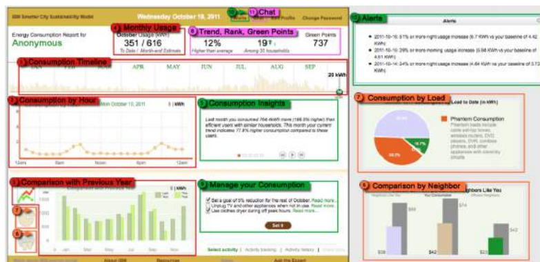
FIGURE 6.3 – EnergyDub [8], un SIP pour la sobriété énergétique utilisant une interface graphique fixe pour informer l’habitant de la consommation d’énergie passée et présente du bâtiment. EnergyDub implémente des mécanismes de jeu (points, classement, etc.).
