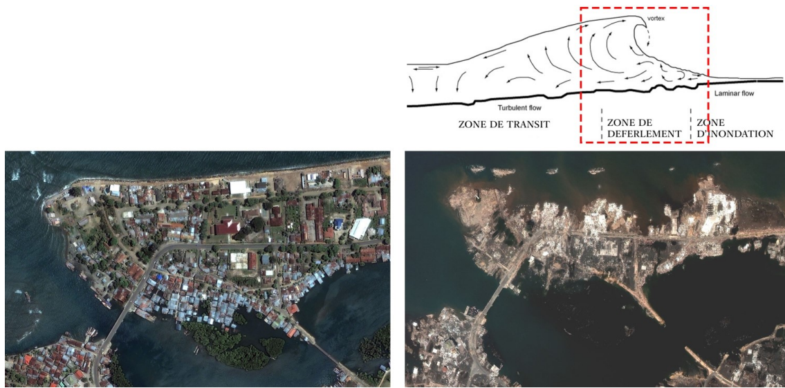
FIGURE 1.18 – Phénomène d'érosion : Avant/Après le tsunami du 26 décembre 2004 à Banda Aceh, Indonésie.
