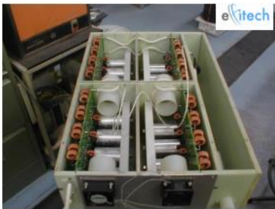
Figure 28 : Exemple de générateur à base de générateur de Marx à fermeture et ouverture [2].
