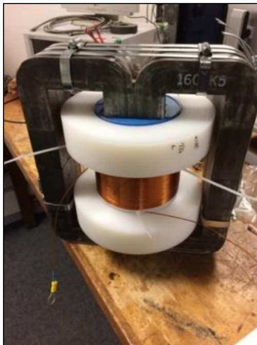
Figure 79 : Photographie du transformateur du modulateur AGIR2.
