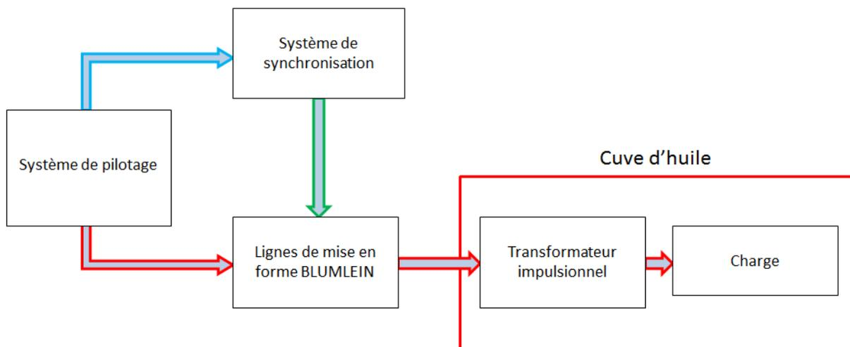
Figure 153 : Synoptique du montage pour les essais.
