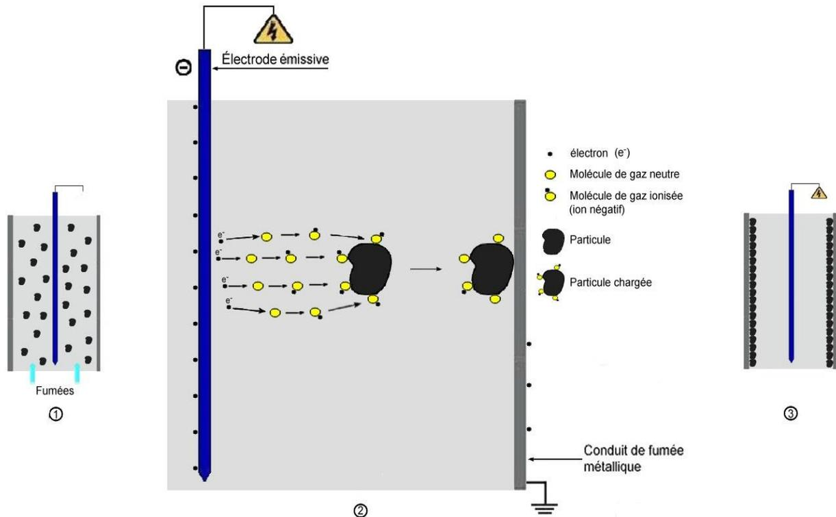
Figure 10 : Principe de fonctionnement d'un électrofiltre [16].
