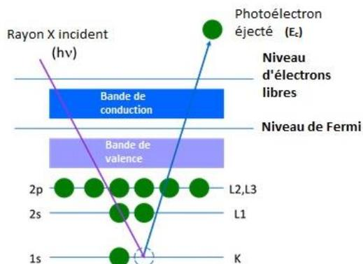
Figure 119 : Principe de fonctionnement de la spectroscopie photoélectronique.
