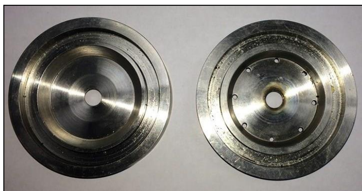
Figure 117 : Photographie de l'électrode de déclenchement en acier inoxydable avant essais à gauche, et après 300 tirs à droite.
