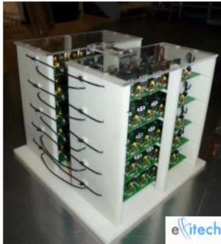
Figure 27 : Circuit-breaker pour la réalisation de générateur à base de commutation de capacité [2].
