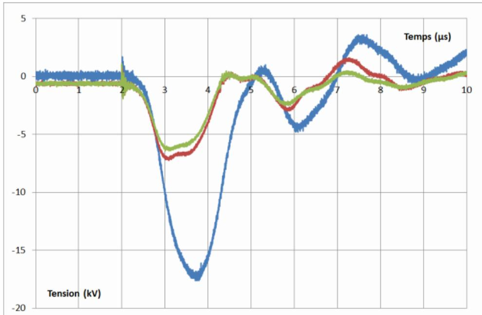
Figure 156 : Mesures de la tension en trois point avant réglage des inductances de liaison(en bleu, la sortie du transformateur en rouge et vert la sortie de deux des générateurs blumleins).
