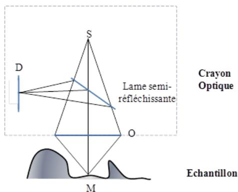
Figure 121 : Principe de la microscopie confocale.
