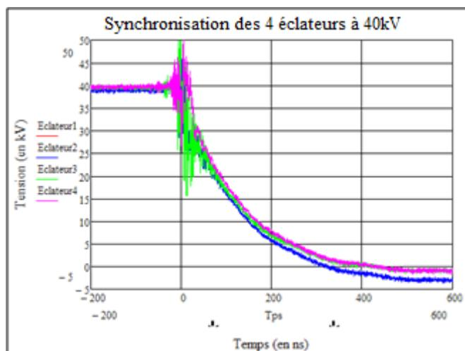
Figure 115 : Mesure des signaux de tension en sortie des quatre éclateurs.
