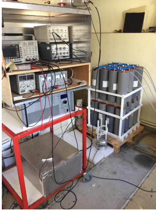
Figure 154 : Photographie du montage pour les essais de synchronisation des 4 lignes BLUMLEIN.
