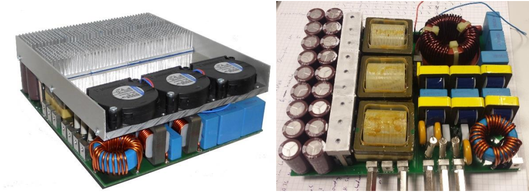
Figure 141 : Convertisseur de Vienne.
