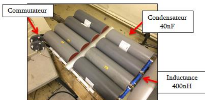
Figure 88 : Photographie du montage d'un générateur BLUMLEIN.
