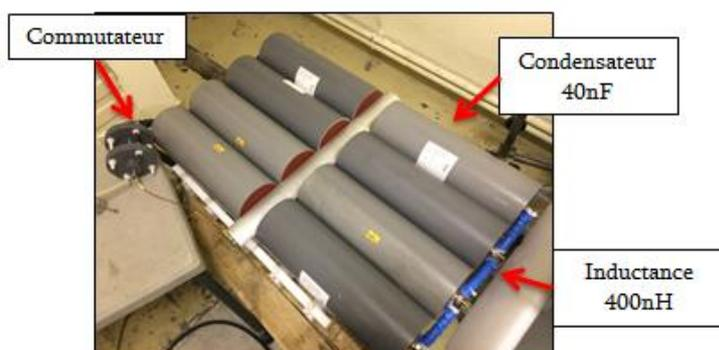
Figure 88 : Photographie du montage d'un générateur BLUMLEIN.
