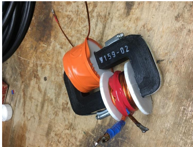
Figure 151 : Photographie du transformateur résonant du convertisseur DC-DC d'AGIR2.
