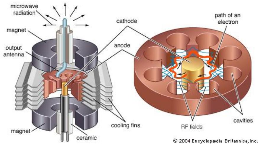
Figure 14 : Schéma de principe d'un magnétron [29].
