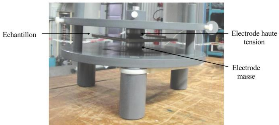
Figure 51 : Photographie du système de test des échantillons [38].
