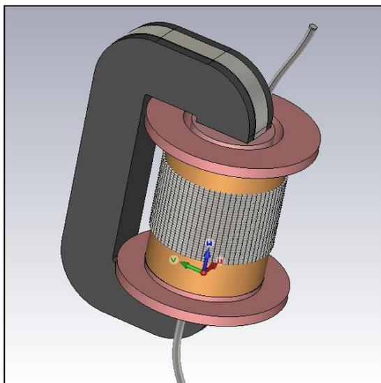
Figure 36: Modèle CST du transformateur AGIR1.
