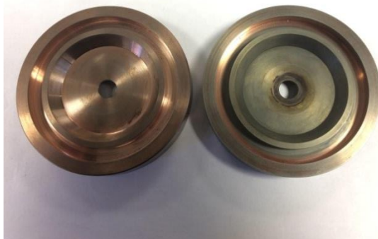
Figure 133 : Photographie de l'électrode de déclenchement en cutène (Cu20W80) avant et après 10 000 tirs.
