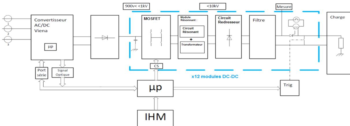
Figure 55 : Synoptique du modulateur AGIR1.
