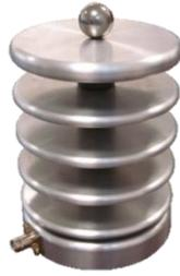
Figure 138 : Photographie de la sonde capacité 600 kV [41].
