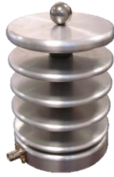
Figure 138 : Photographie de la sonde capacité 600 kV [41].
