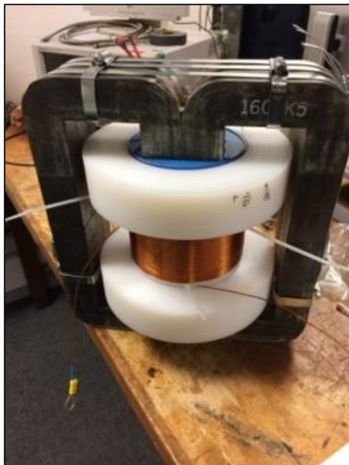
Figure 79 : Photographie du transformateur du modulateur AGIR2.
