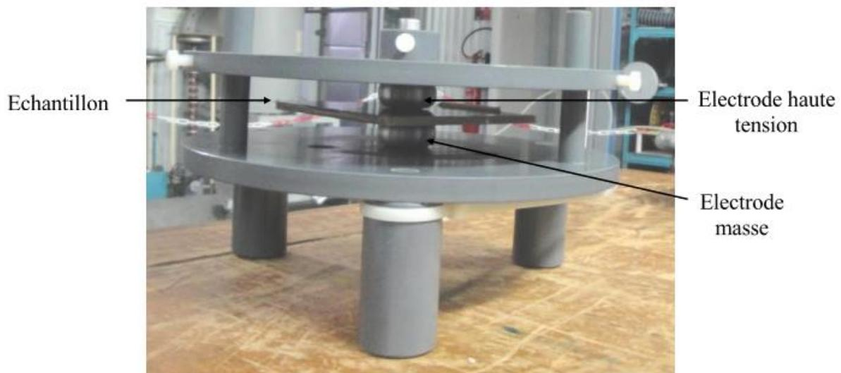
Figure 51 : Photographie du système de test des échantillons [38].
