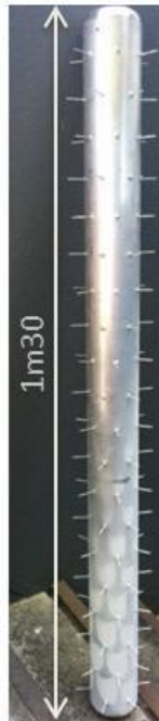
Figure 110 : Dépôt de poussières sur l'électrode émettrice
