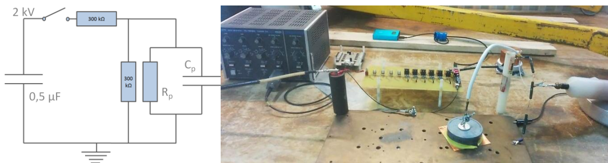
Figure 66 : Schéma et photographie du dispositif expérimental sous tension impulsionnelle
