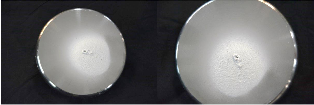
Figure 97 : Rupture diélectrique de la couche de dépôt à -16 \text{ kV}_{DC}
