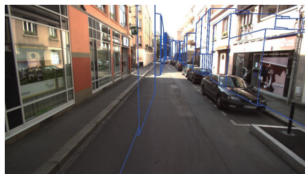
(a) Résultat d'affichage des données SIG 2,5D à partir de la localisation initiale
