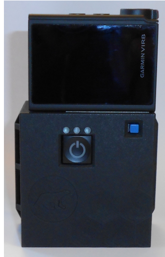
FIGURE 5.19 – Capteur ULISS et caméra Garmin fixés ensemble [extrait de [ASR18a]].
