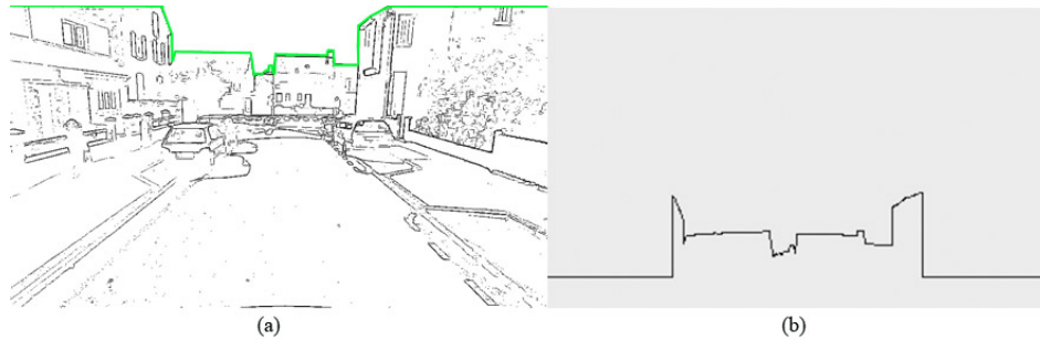
FIGURE 5.11 – Ligne de ciel extraite (vert) en utilisant un seuillage adaptatif [extrait de [ZPS + 12]].
