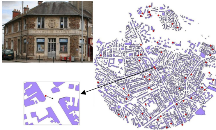
FIGURE 5.9 – Exemple d'image et de poses résultats avec uniquement une requête basée sur la façade gauche et la façade du milieu. La pose exacte est indiquée en bas à gauche [extrait de [BMS08b]].
