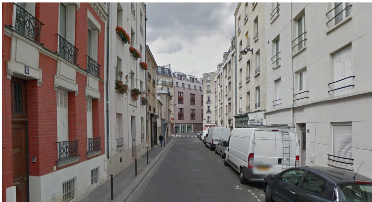
Figure 41 : La ligne de plot sur trottoir, un triple dispositif de sécurité routière, de lutte contre le stationnement sauvage, et d'accessibilité 196 .
