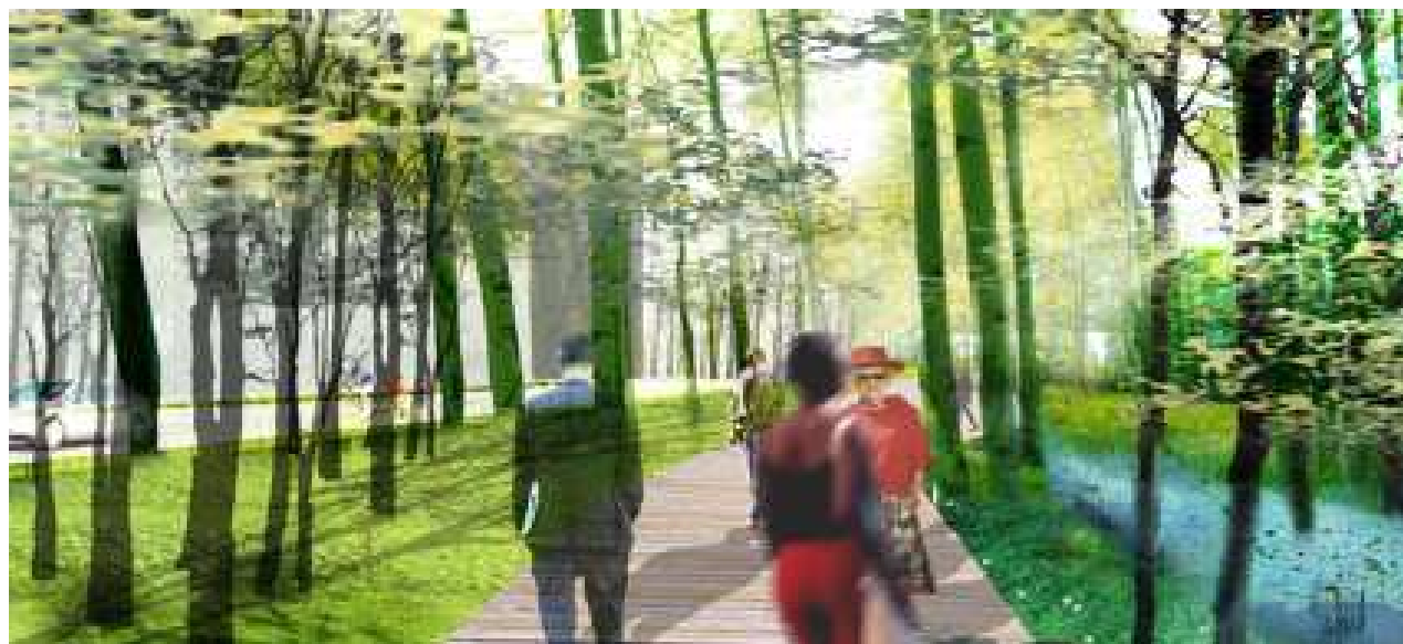
Fig. 27 - ZAC Claude Bernard, Paris 19 ème , Forêt linéaire le long du boulevard périphérique © Agence TER Paysagistes Paris, 2009. Une rangée d'arbres, dite « forêt linéaire », est plantée le long du boulevard périphérique pour la promenade mais aussi pour atténuer les nuisances dues à la circulation automobile. Une noue est prévue au pied du talus pour récupérer les eaux de pluie et irriguer les plantations.
