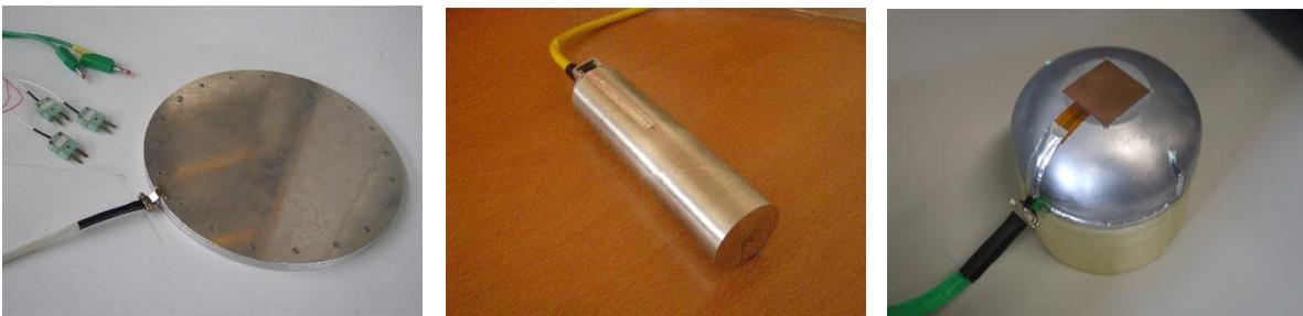
**Figure 9. Pièces d'aluminium instrumentées pour l'évaluation des coefficients de transferts de chaleur dans le tunnel.**
