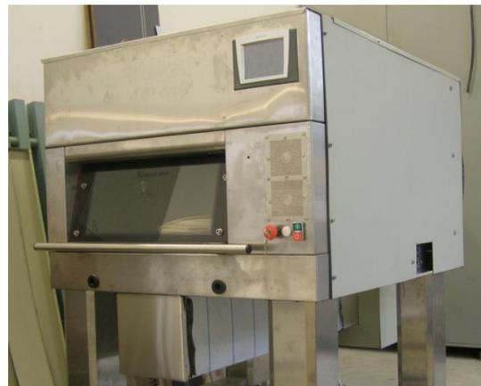
Figure 14. De la conception à la réalisation du four à jets en impact
