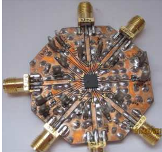
Figure I-45 : PCB permettant la caractérisation de l'OCT élémentaire.
