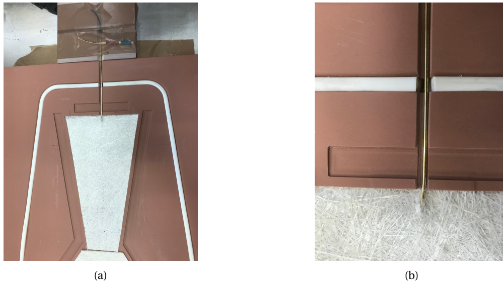
FIGURE II.11 – (a) Mise en place dans le demi-moule intrados du demi-profil drapé et recouvert de mat, (b) Détail de l'arrangement du demi-moule intrados pour laisser passer les connecteurs de la fibre optique placée dans le matériau.
