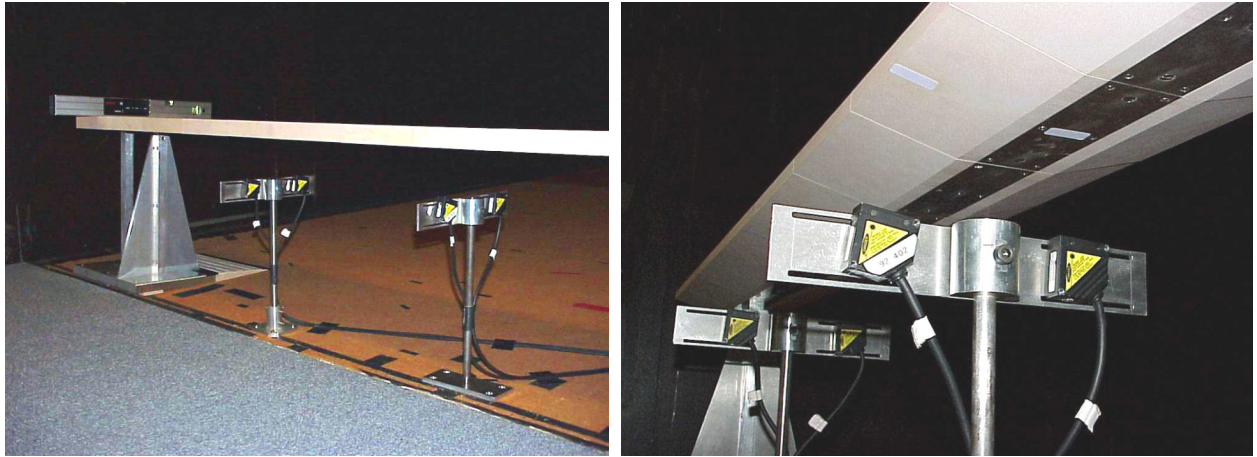
Figures 5.35 et 5.36 – Capteurs de déplacements et étiquettes de visée
