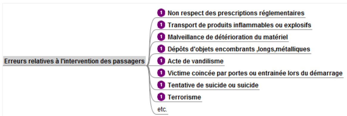
Figure 4.4. Un échantillon d'instances pour les erreurs relatives à l'intervention des passagers (Hadj-Mabrouk A. and Hadj-Mabrouk H., 2003).
