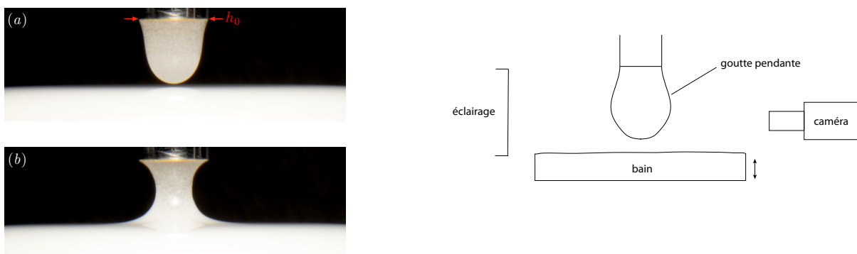
FIGURE 2.1 – Gauche : pont capillaire instable formé par la coalescence d'une goutte pendante de suspension avec un bain. Droite : schéma de l'expérience.
