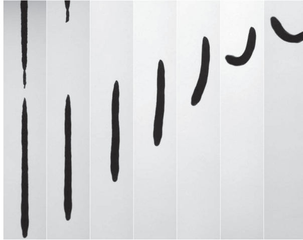
FIGURE 3.23 – Relaxation de la forme d’une goutte primaire au cours de sa chute. La dérive vers le haut de l’image est dû au fait que la caméra, lâchée au cours de cette expérience, ne chute pas exactement à la même vitesse que la goutte. Sur la dernière image, la goutte se situe à environ 130 cm de la buse.
