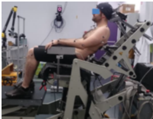
FIGURE 1.7 – Participant, équipé de marqueur, assis sur le conformateur (i.e. siège instrumenté). Assise à 5^\circ par rapport à l’horizontale, angle dossier-assise de 130^\circ .
