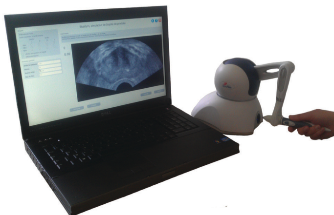
Figure 5.1 : Architecture de la 3 ème version du simulateur Biopsym
