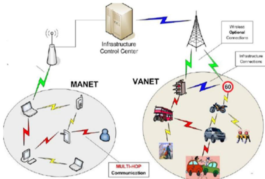
Fig. 2.3 Vehicle Ad Hoc Network (VANET) [56]
