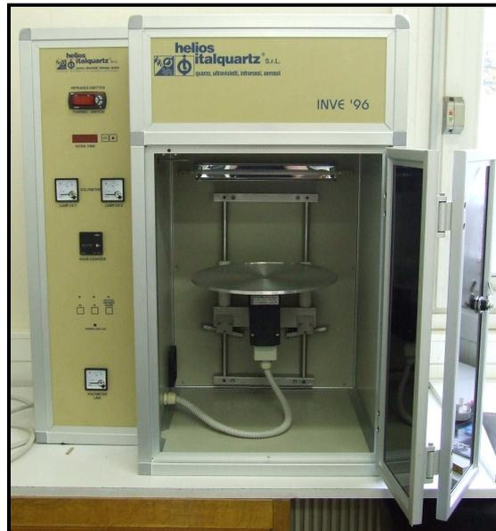
Figure 3- 15: Dispositif de vieillissement UV.
