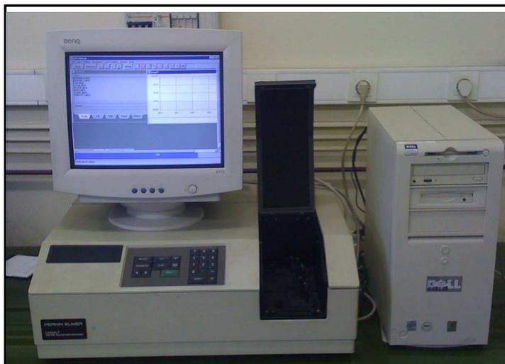
Figure 3- 13: Spectrophotomètre Lambda 2 UV/VIS de PERKIN ELMER
