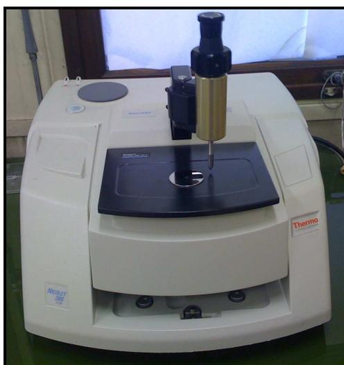
Figure 3- 14 : Spectromètre infrarouge à transformée de Fourier Nicolet 380
