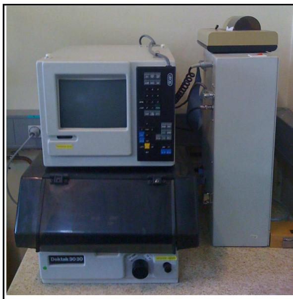
Figure 3- 17 : Profilomètre Dektak 3030
