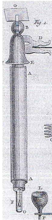
Anémomètre à pression de type tubulaire (Gusteau) décrit par Cotte en 1788
