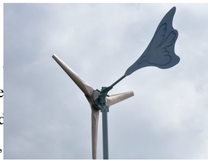
Figure 28. Eolienne Piggott construite en 2013 par le réseau Tripalium (autoconstruction d'éolienne) à Brenas (34)
