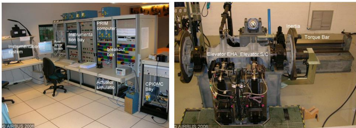
Figure 3.24 – Banc d'intégration système couplé au banc actionneur
