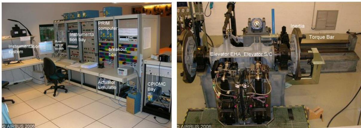
*Figure 3.24 – Banc d'intégration système couplé au banc actionneur*
