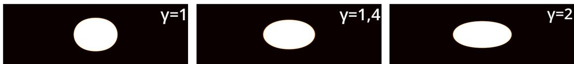
FIGURE 3.18 – Illustration, à l'aide du champ  $\varphi$ , de la morphologie du précipité à l'instant t=204s pour 3 ratios d'anisotropie différents
