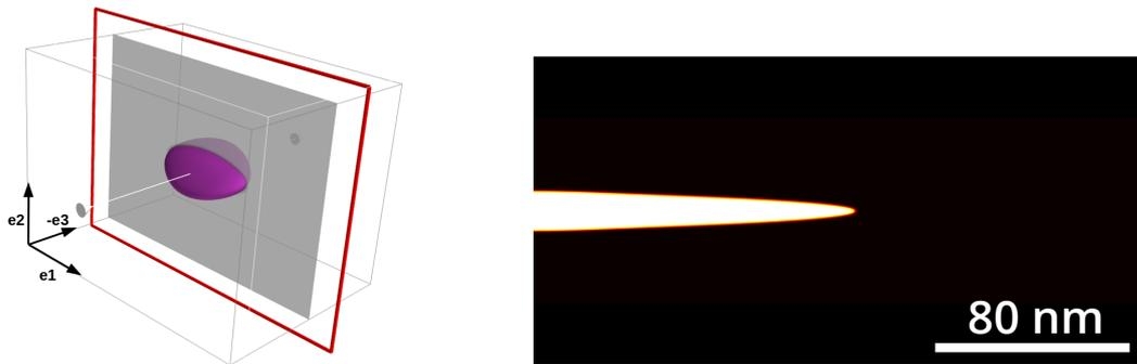
FIGURE 3.22 – Gauche : Illustration, à l'aide du champ  $\varphi$  d'une plaquette de titane en cours de croissance à  $t=0,5s$  et plan de coupe (en gris) dans lequel les simulations en 2D ont été menées – Droite : Illustration, à l'aide du champ  $\varphi$ , d'une plaquette de titane en cours de croissance à  $t=3,5s$
