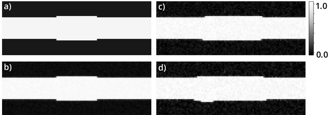
FIGURE 4.7 – (a) Illustration du champ  $\varphi$  à l'état initial – (b) Illustration, après 6000 pas de temps de l'absence de propagation des marches pour  $T=25K$ , (c) de la propagation des marches pour  $T=150K$  et (d) de la propagation des marches accompagnée de nucléation pour  $T=450K$
