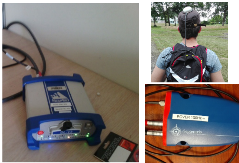
Figure 58: Illustrations du matériel utilisé pour obtenir la solution de référence : À gauche la base « Novatel » située à proximité du lieu de l'expérimentation. À droite, le récepteur mobile « Septentrio » porté par les piétons durant l'expérimentation.
