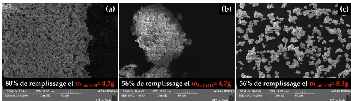
Figure 2.52 : évolution de la morphologie des cristaux suivant le pourcentage de remplissage de l'autoclave et en fonction de la masse de cristaux ajoutée.
