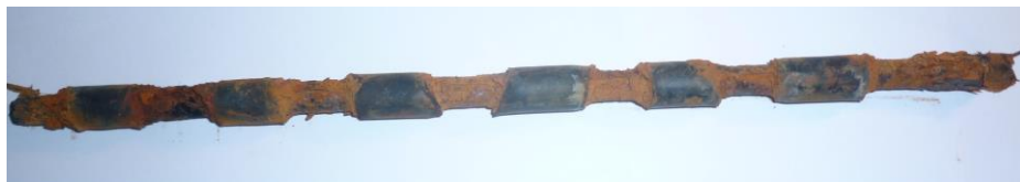
Figure 45 : Vue du CFO à la fin de l'essai de corrosion accélérée (connecteur sur gaine noire, à droite)
