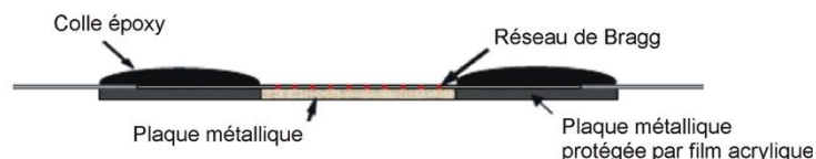
Figure 21 : Schéma de du CFO de corrosion proposé par J-R Lee et al. [61]
