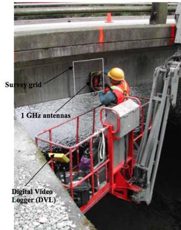
Figure 9 : Exemple d'auscultation par GPR Source : Csaba 2007 [33]
