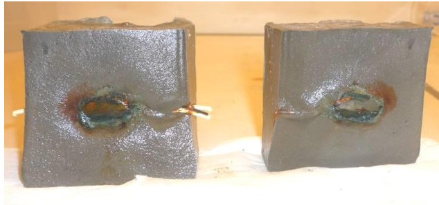
Figure 28 : Fracture de l'échantillon L'éclatement est dû aux contraintes internes par l'accumulation des produits de la corrosion (rouille) qui ne peuvent être évacuées à la surface
