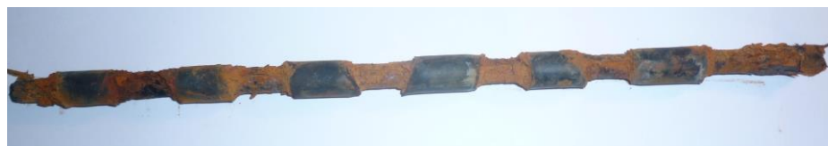
Figure 45 : Vue du CFO à la fin de l'essai de corrosion accélérée (connecteur sur gaine noire, à droite)
