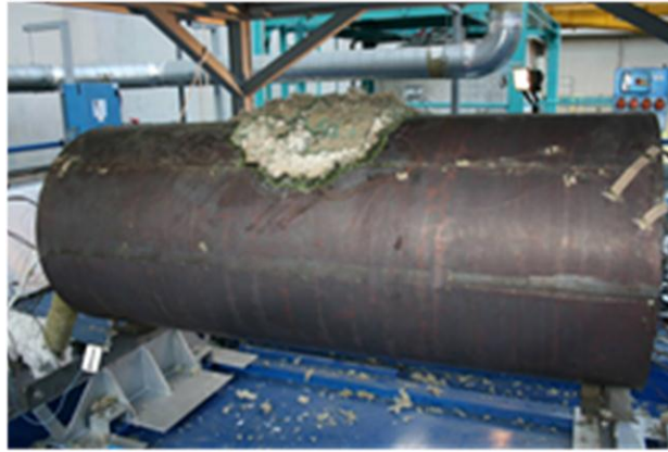
Figure 41 : Photographie de la maquette de la canalisation de sodium liquide après l'expérience de fuite. On peut observer la formation d'une croûte sur le dessus, résidus du calorifuge consommé par le sodium liquide.
