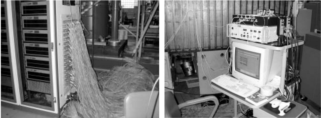
Figure 26 : Photographie du câblage des 466 gauges de contraintes (à gauche) et système de mesure optique des 3000 réseaux de Bragg (à droite) lors de la mesure de la déformation sur un prototype d'aile d'avion, d'après [34].
