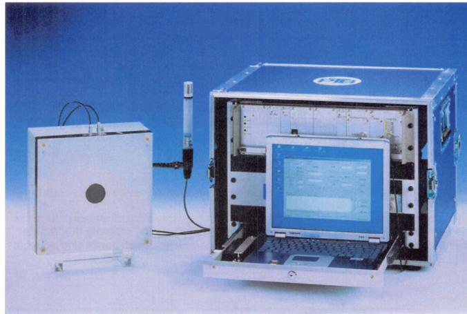
*Figure VI.3 : détecteur de transfert du PTB avec ses instruments de mesure associés*
