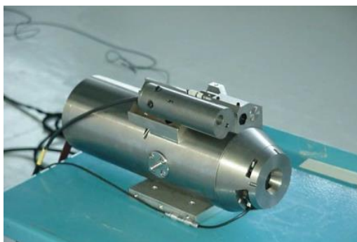
Figure 1-17 : Caméra gamma Aladin (MAHE, 2011).
