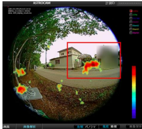
Figure 1-8 : Localisation de points chauds radioactifs sur le site de Fukushima avec ASTROCAM 7000HS (TAKEDA & al., 2015).
