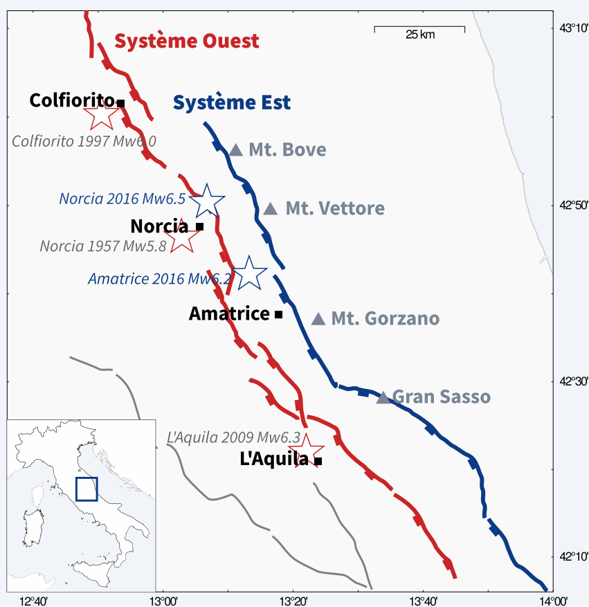
FIGURE 3.1 – Contexte sismo-tectonique de l'Apennin Central. L'extension est accommodée par deux systèmes parallèles, constitués de failles normales : le système Ouest (en rouge) et le système Est (en bleu). Le séisme d'Amatrice de 2016 a rompu une partie du système Est.
