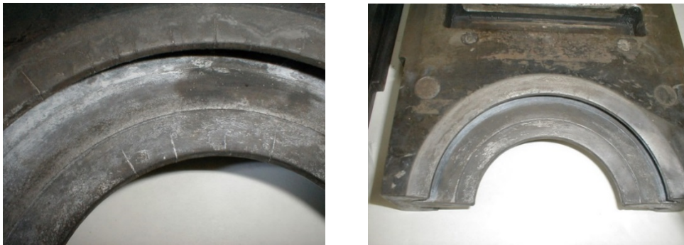
Figure 1.20 : Moule de fonderie en aluminium présentant des fissures (à gauche). La même pièce réparée par Cold Spray, réusinée pour éliminer l'excédent de poudre, puis retestée en conditions de moulage pour valider la résistance des réparations après 1000 cycles (à droite) [43]
