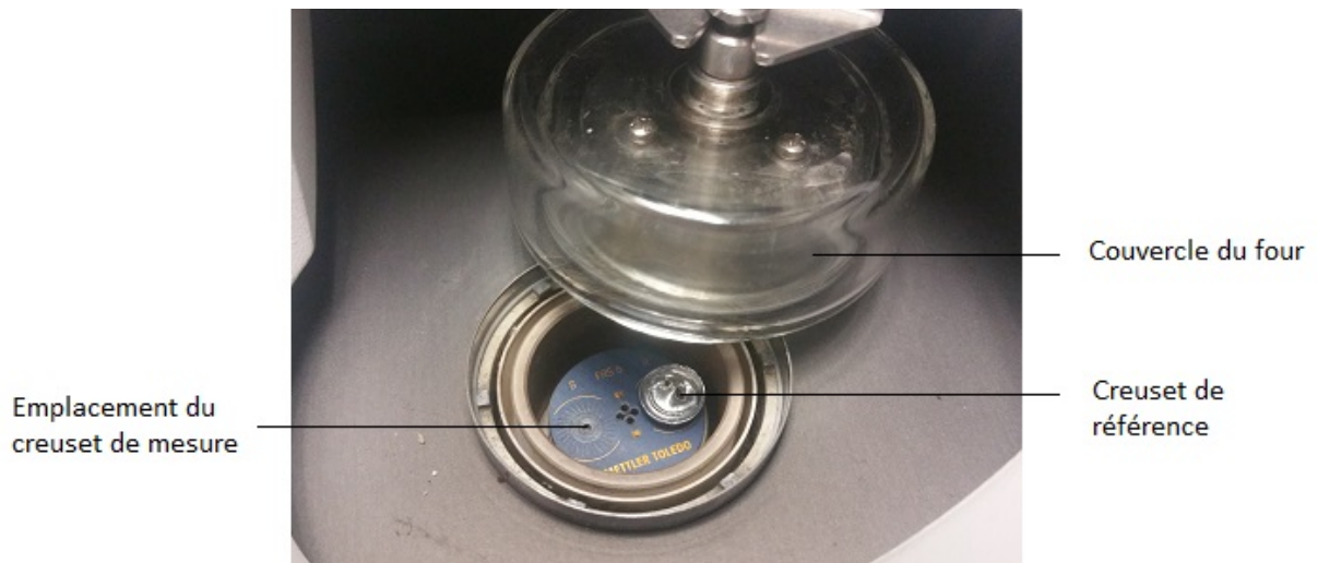
Figure 2.27 : Four et cellule de mesure FRS 5 de la machine DSC 1 STAR System
