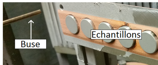
Figure 2.8 : Support utilisé pour projeter sur les pions en aluminium utilisés pour les essais d'adhérence, la zone balayée par le robot est visible avec le cuivre déposé sur le support
