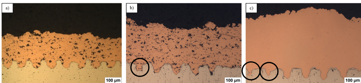
Figure 4.21 : Observation en coupe de dépôts réalisés sur substrats texturés avec a) le laser nanoseconde, b) et c) la plateforme en cours de développement
