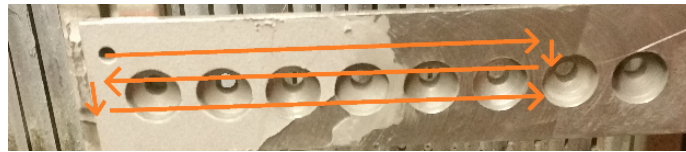
Figure 4.8 : Schéma présentant le balayage du robot devant le support
