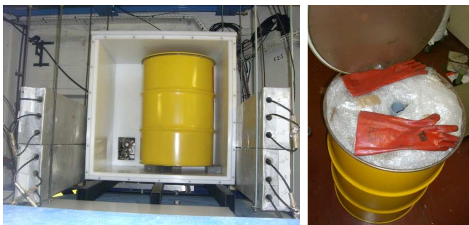
Figure 4.27 : À gauche : fût de 220 L placé dans la cellule de mesure d'interrogation neutronique active (face arrière retirée). À droite : fût contenant une matrice vinyle de 0,02 \text{ g/cm}^3 .
