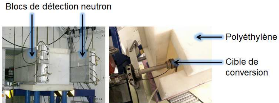
Figure 3.3 : À gauche : maquette de cellule neutronique basée sur un accélérateur d'électrons. À droite : tête de l'accélérateur d'électrons à l'entrée de la cellule.
