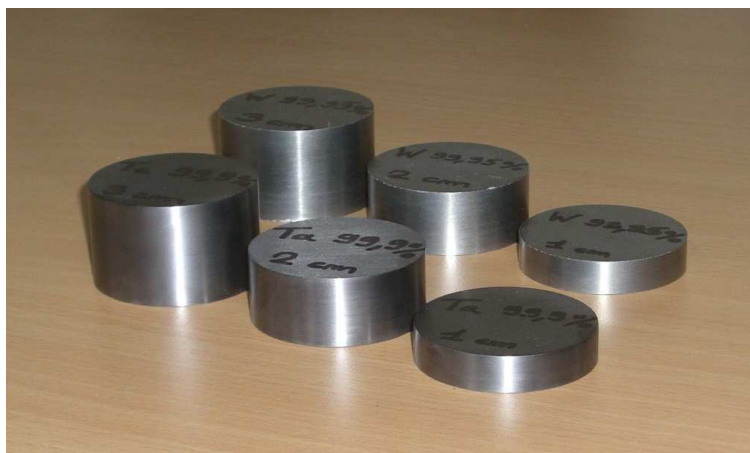
Figure 4.33 : Cibles de tungstène ou de tantale de différentes épaisseurs (1 cm, 2 cm et 3 cm).
