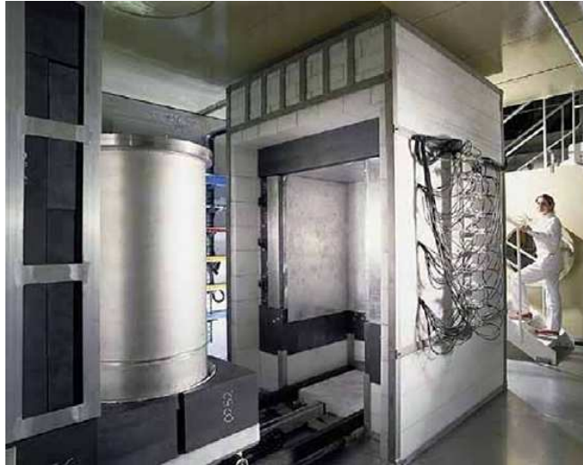
Figure 1.4 : SYMETRIC : cellule dédiée à la mesure par interrogation neutronique active.
