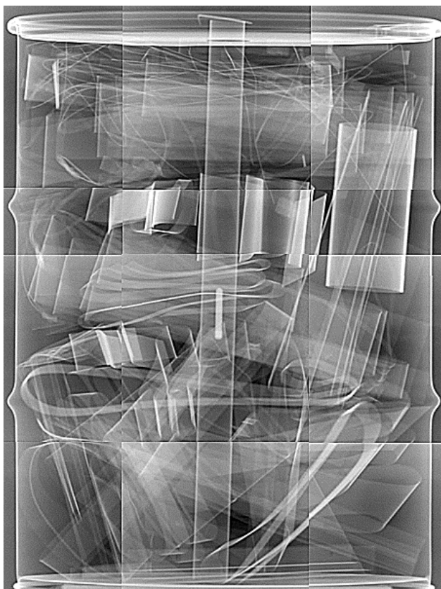
Figure 4.29 : Image haute énergie d'un fût de 220 L contenant une matrice fer de 0,22 \text{ g/cm}^3 , image traitée à l'aide du logiciel Photoshop CS5.
