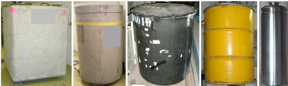
Figure 1.1 : Différents types de colis de déchets radioactifs. De gauche à droite : bloc TE, coque CBFC-2, fût de 870 L, fût de 220 L, colis CSDC.
