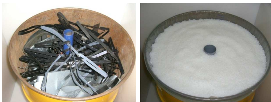
Figure 4.28 : À gauche : fût contenant une matrice fer de 0,22 \text{ g/cm}^3 . À droite : fût contenant une matrice polyéthylène de 0,45 \text{ g/cm}^3 .
