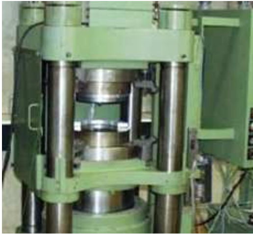
Fig. 17 - Presse de dépôt HPHT de diamant (à gauche) et gemmes obtenus par selon ce procédé (à droite).
