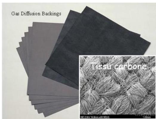
**Figure II. 5 :** Tissu en carbone poreux conducteur E-Tek®.
