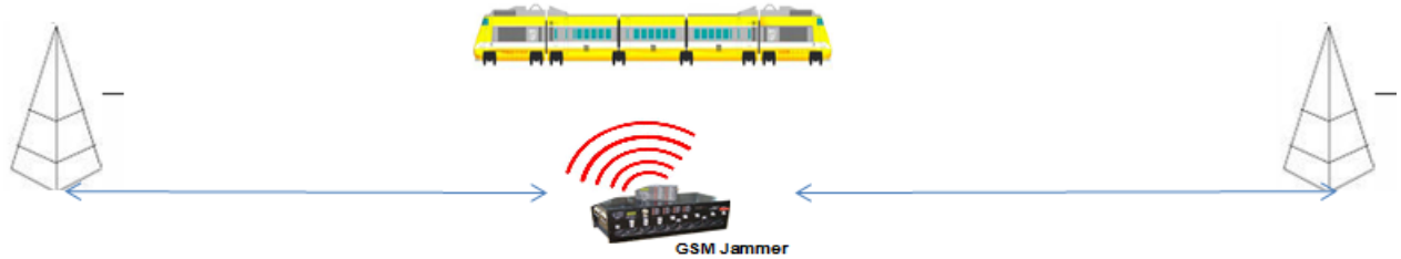
Figure 2.17 Brouilleur placé entre deux BTS.
