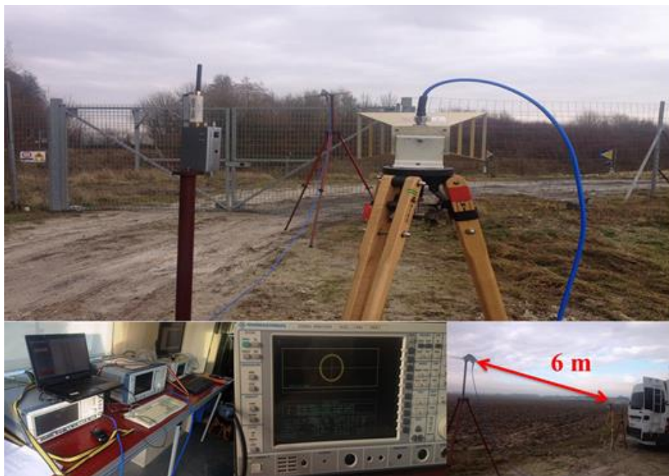
Figure 4.10. Campagne de mesure le long d'une ligne à grande vitesse.
