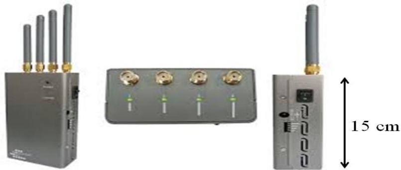
Figure 2.21 Brouilleur de poche utilisé lors des essais.
