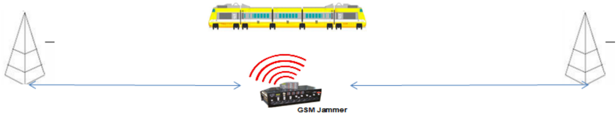
Figure 2.17 Brouilleur placé entre deux BTS.
