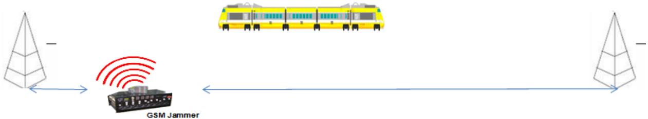
Figure 2.16 Brouilleur à proximité d'une BTS
