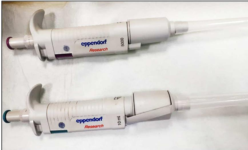
**Figure 2.14:** Micropipettes Eppendorf (5000  $\mu\text{L}$  et 10 mL) utilisées pour le prélèvement des volumes de solution.
