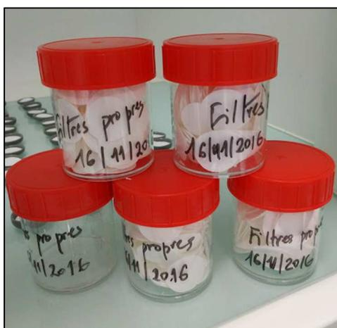
**Figure 2.13:** Boîtes de filtres propres référencés par date.
