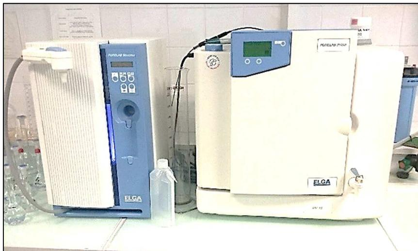
**Figure 2.9:** Syst me de purification d'eau ELGA utilis  au Laboratoire de chimie du Labotroire d'A rologie
