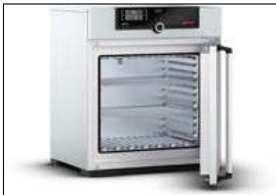
**Figure 2.12:** Etuve de marque Memmert utilisée pour le séchage des filtres
