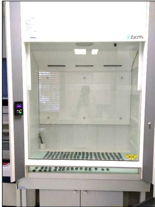
**Figure 2.11:** Hotte à flux laminaire IBERIS utilisée pour le séchage des éléments lavés.
