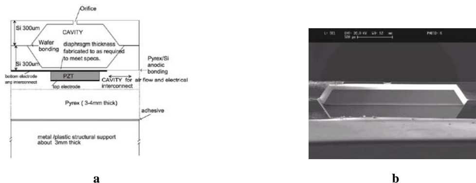
Figure 6.15 - a) Schéma d'un actionneur de type micro jet synthétique, b) Coupe transversale d'un générateur de micro jet synthétique [10]
