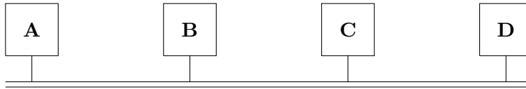
FIGURE 2.1 – Exemple de réseau en bus
