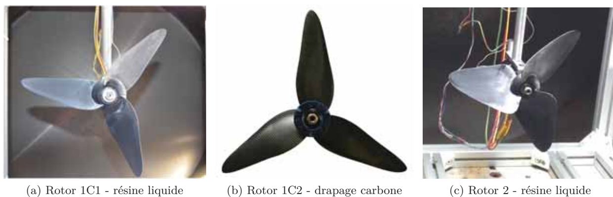
FIGURE 8.5. – Rotors optimisés par théorie des éléments de pale
