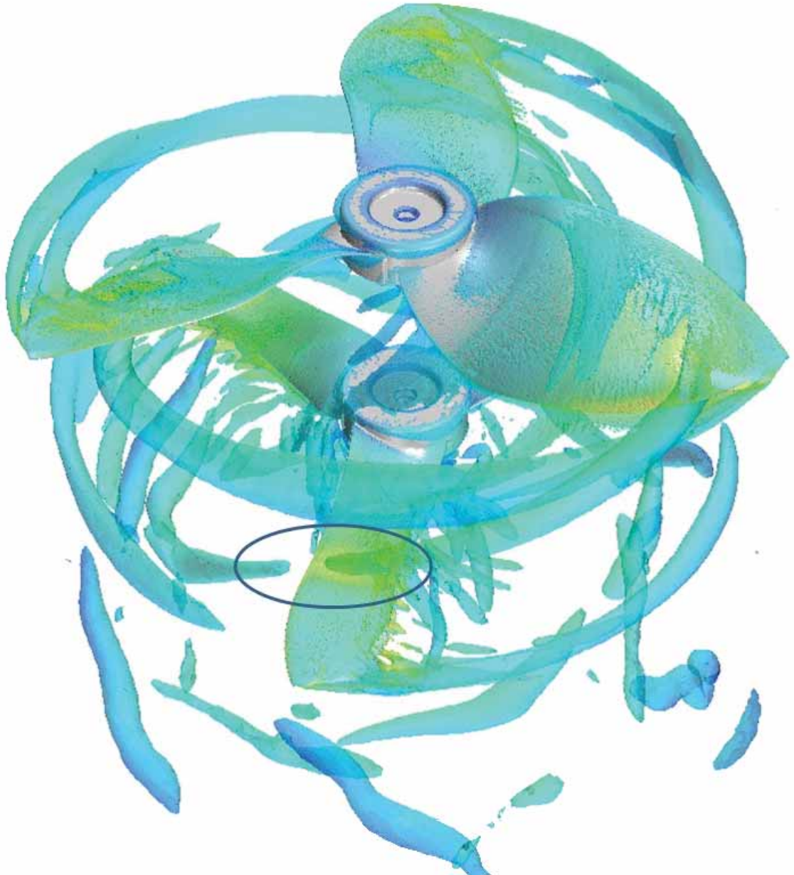
FIGURE 7.36. – Illustration de l’interaction des structures tourbillonnaires générées par le bout de pale du rotor supérieur avec le rotor inférieur (entourée en bleu) - Iso-surfaces de critère Q ( Q= 2.10^6 ) à \Omega_{sup} = 6100 tr/min et \Omega_{inf} = 8500 tr/min colorées par la vitesse (StarCCM+)
