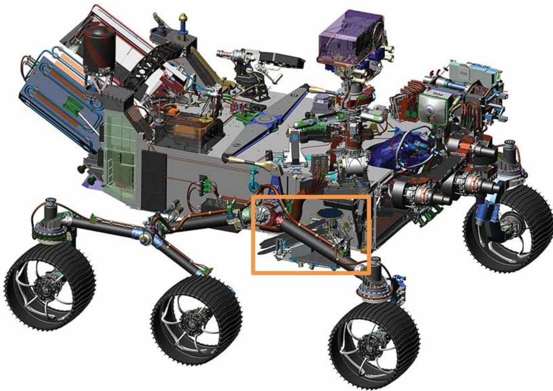
FIGURE 1.6. – Schéma du rover Mars 2020 avec le drone replié à l'intérieur (entouré en orange) - Source : NASA/JPL-Caltech
