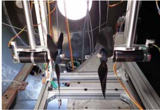
FIGURE 8.4. – Configuration coaxiale du banc de mesure
