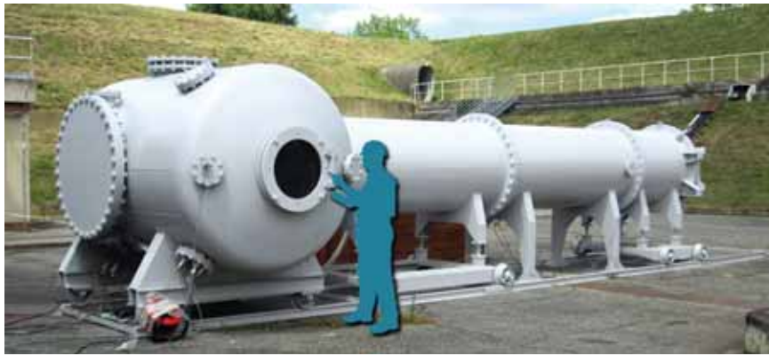
FIGURE 8.1. – Caisson de haute altitude avec silhouette humaine
