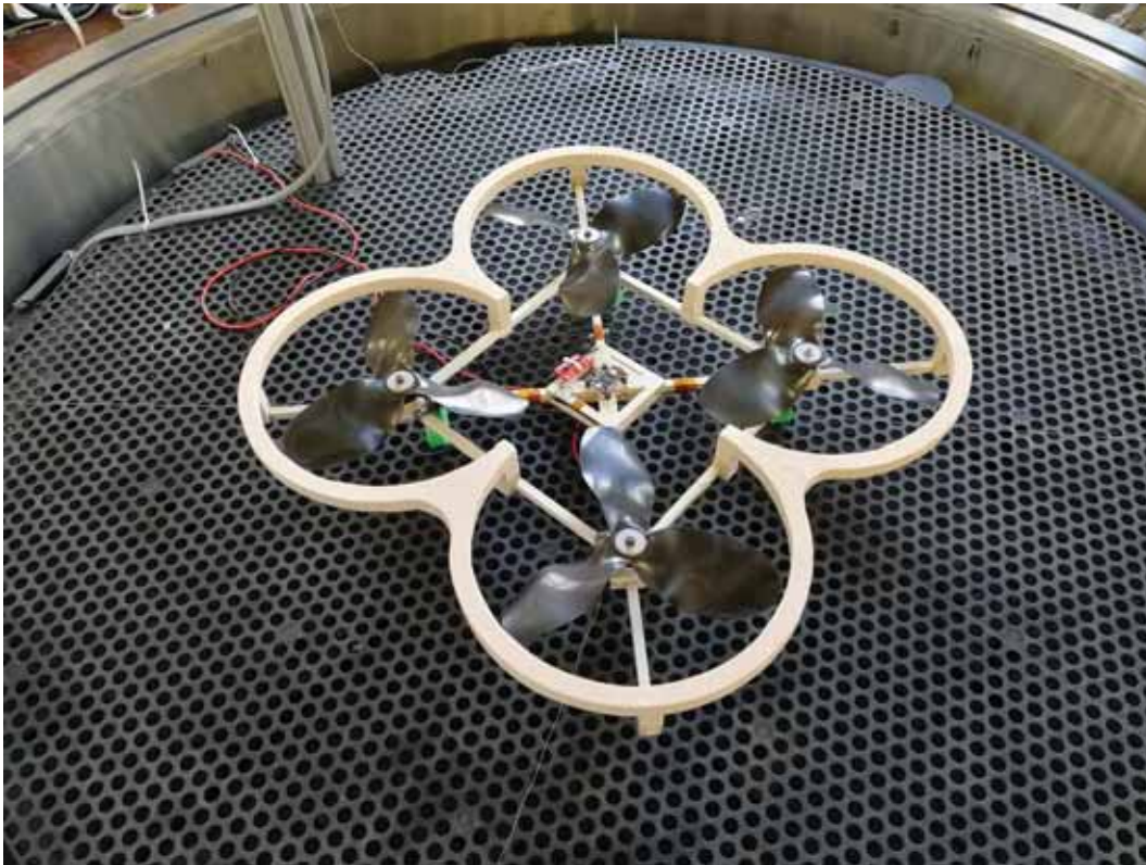
FIGURE 9.1. – Démonstrateur du Stratodrone dans l'enceinte dépressurisée du CNES (SIMEON)
