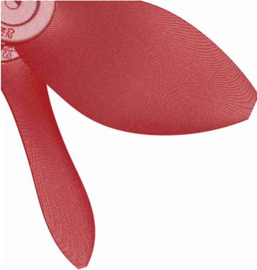
FIGURE 7.33. – Visualisation de la densité de maillage des pales de rotors coaxiaux
