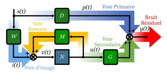
FIGURE 1.14. Schéma de commande Feedforward.
