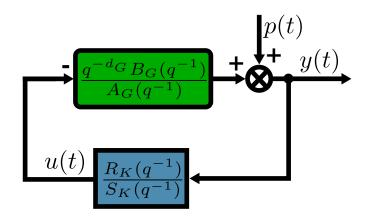
FIGURE 1.10. Schéma de régulation en Feedback.
