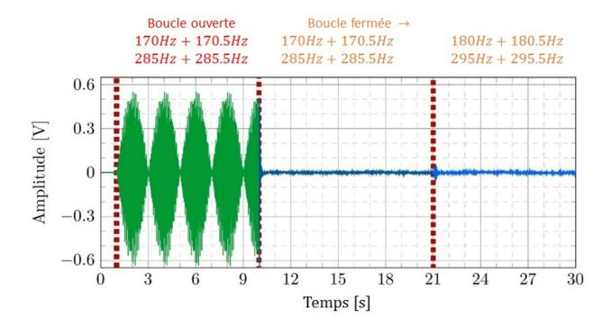
FIGURE 1.12. Atténuation des interférences acoustiques par un contrôleur adaptatif en feedback avec paramétrage YK.
