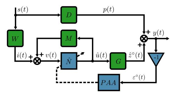
FIGURE 1.15. Schéma de commande Feedforward avec PAA.
