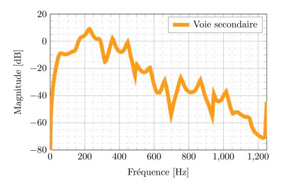
FIGURE 1.9. Caractéristique fréquentielle de la voie secondaire identifiée pour la première configuration du banc d'essai.
