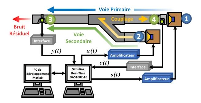
FIGURE 1.6. Schéma de la première configuration du banc d'essai.
