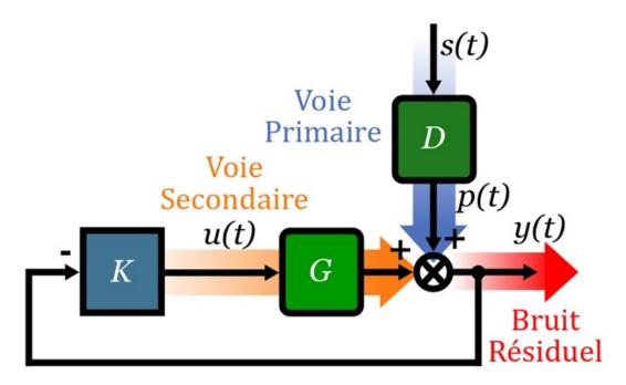
FIGURE 1.7. Schéma de commande Feedback.
