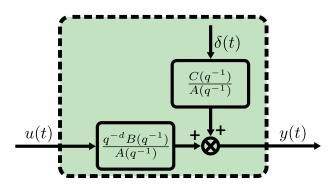
FIGURE 1.8. Diagramme de processus ARMAX.
