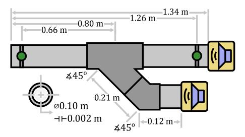
FIGURE 1.4. Première configuration du banc d'essai expérimental.
