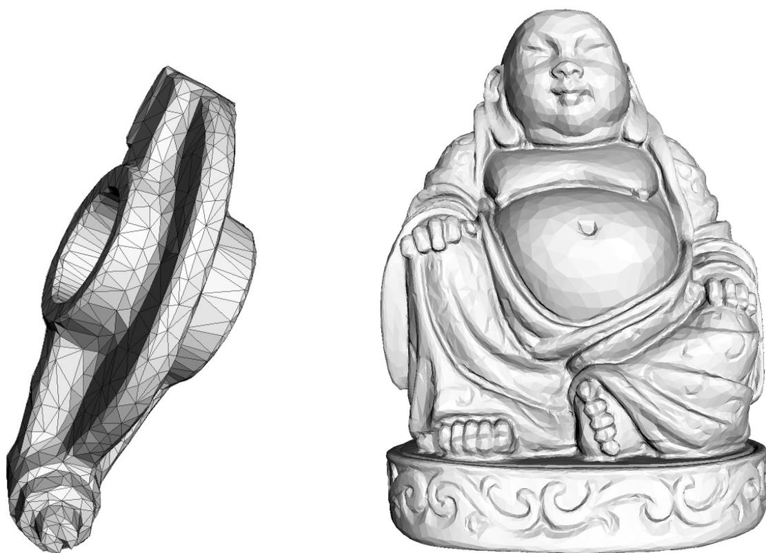
FIGURE 4.12 – Simplifications des modèles *rockerarm* (1000 sommets) et *Buddha* (20k sommets).
