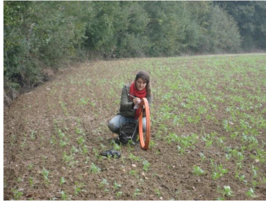
Figure 47 : Cadre récepteur d'EM34 en position verticale
