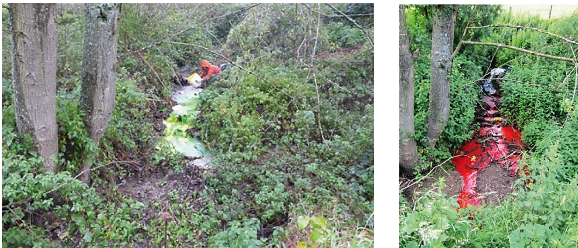
Figure 83 : Traçages à la fluorescéine en novembre 2013 (à g.) et à la sulforhodamine en juillet 2013 (à d.), à la perte du Bébec
