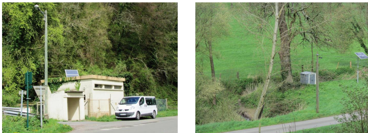
Figure 38 : Alimentation par panneaux solaires de l'instrumentation (à g. à la source ; à d. à la perte)
