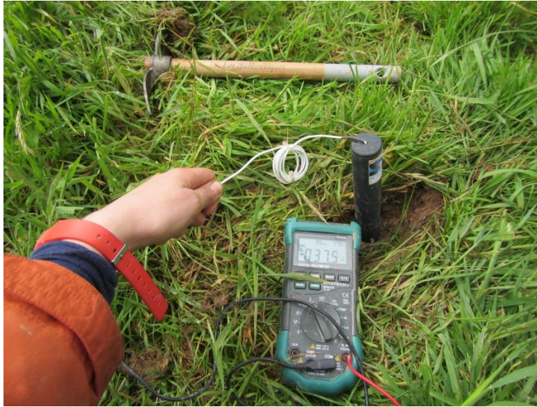
Figure 50: Dispositif de mesure de potentiel spontané employé sur le terrain
