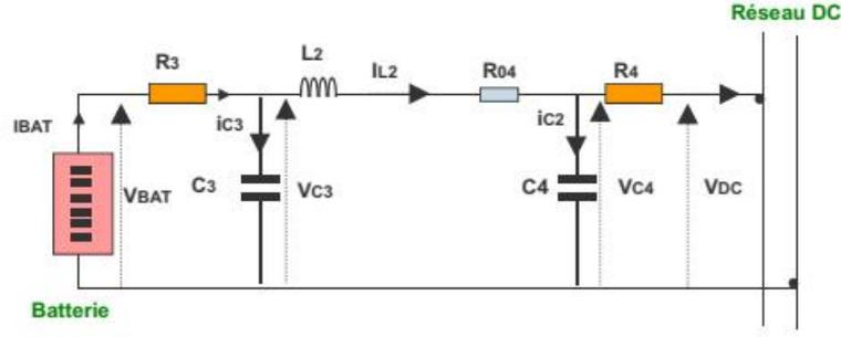
Figure 3.25: Structure convertisseur DC/DC dans l'intervalle  $[u_2T, T]$
