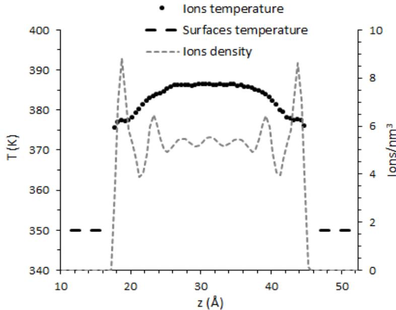
**Figure i-12. Profile de température typique dans un contact nano-confiné. Ici, pour une vitesse de cisaillement  $U = 40$  m/s.**
