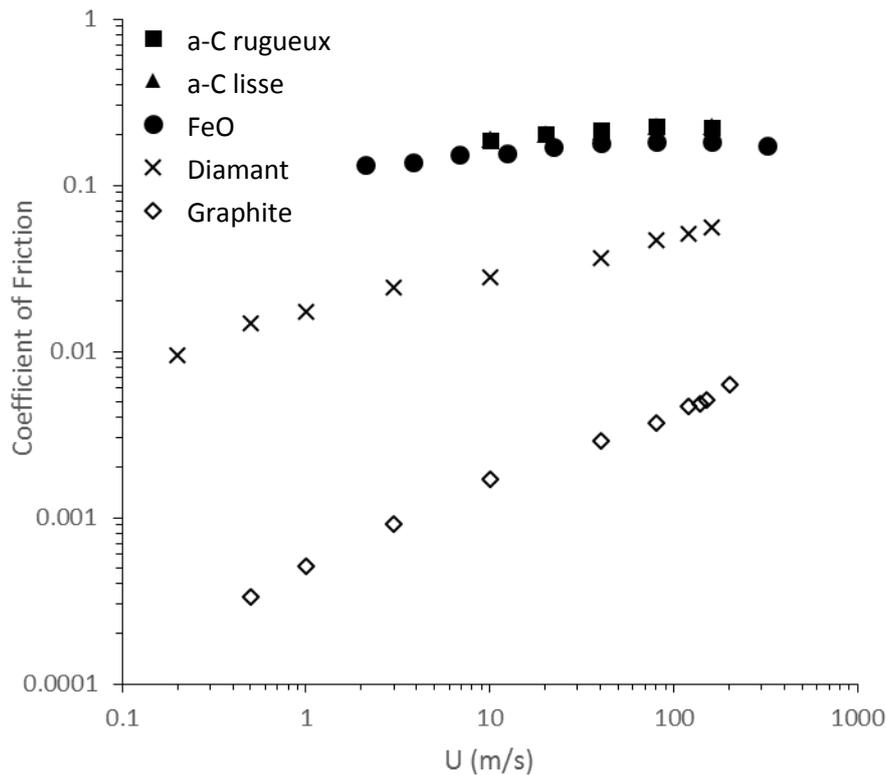
**Figure i-14. Coefficient de frottement du système cisailé avec une charge normal de 500 MPa pour cinq surfaces différentes.**
