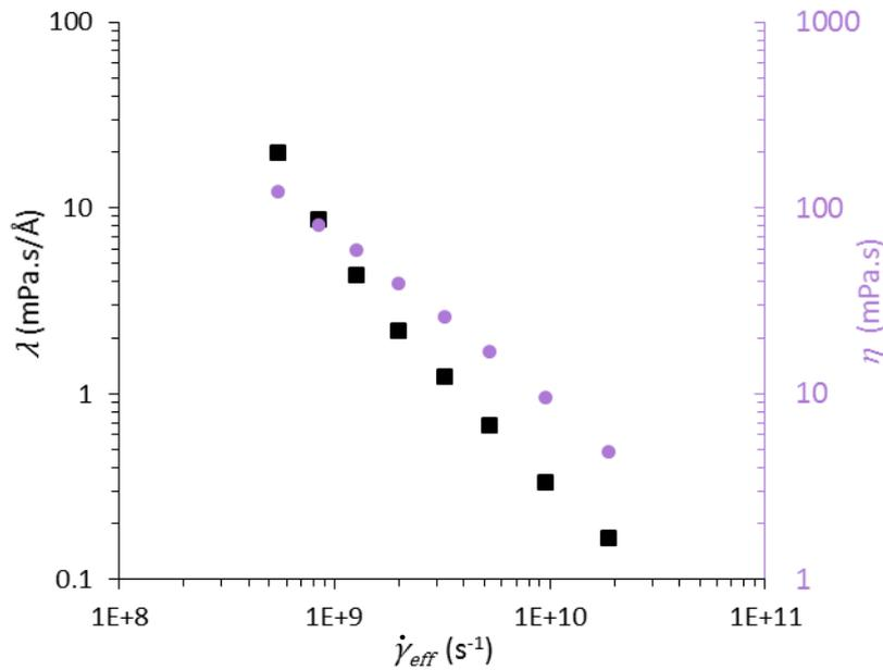
**Figure i-10. Variation du coefficient de frottement fluide  $\lambda$  à l'interface IL/FeO et de la viscosité du LI  $\eta$  en fonction du taux de cisaillement effectif.**
