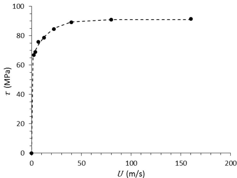
**Figure i-9. Evolution de la contrainte de cisaillement  $\tau$  dans le nano-contact lubrifié en fonction de la vitesse de cisaillement, pour une pression de confinement de 500 MPa et une température des parois fixée à 350 K.**
